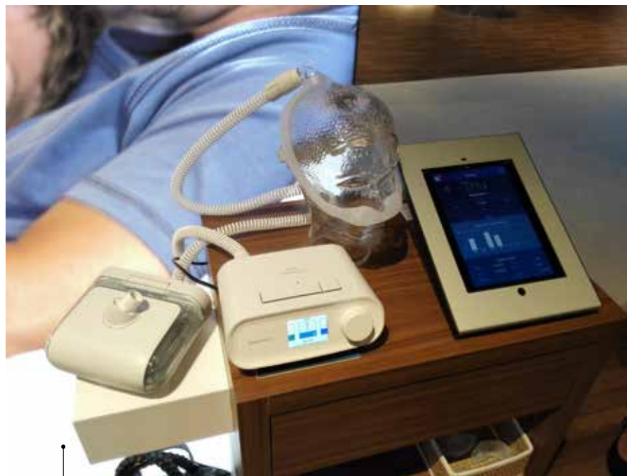
La Philips DreamStation, destinée aux personnes sujettes à l'apnée du sommeil, se pilote via une tablette ou un Smartphone
